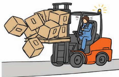
Riesgo: carga sin sujeción
