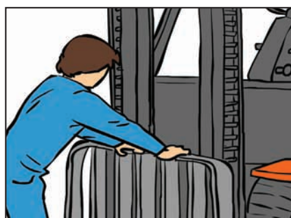
La existencia de grietas o deformaciones en el respaldo de la carga
