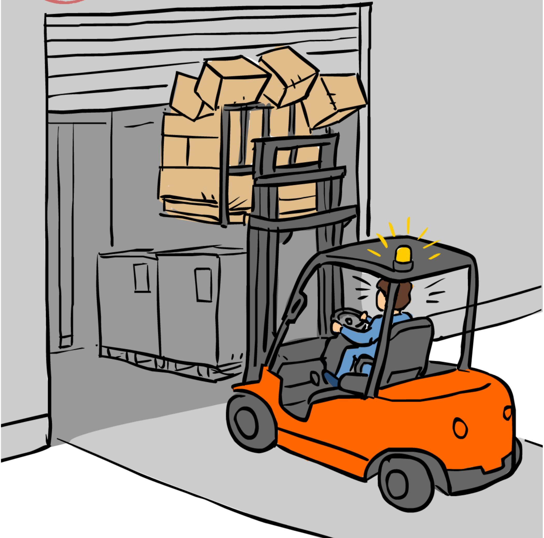
No manejes la carretilla con la **carga levantada**
