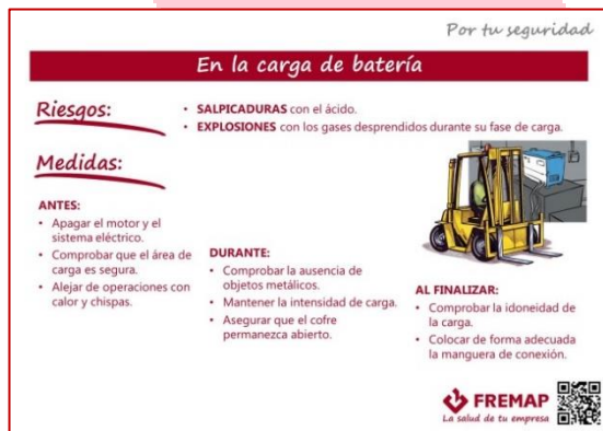
En la carga de batería
